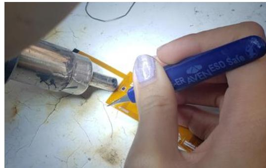
Nota: La pistola de calor debe estar a una temperatura de 260° y la presión del aire en 4.5
