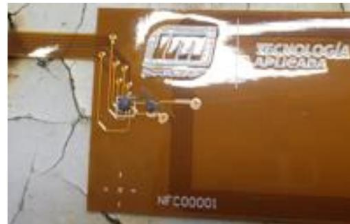
2.- Tomar un IC00157 con las pinzas y colocarlo en su posición. Aplicarle calor hasta que seque la soldadura.
