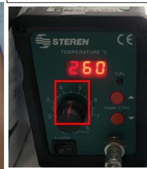
3.- Tomar un CS00040 con las pinzas y colocarlo en su posición. Aplicarle calor hasta que seque la soldadura.
