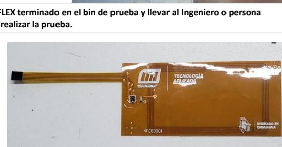
5.- Colocar los FLEX que hayan pasado la prueba en el bin de producto terminado. Los que hayan fallado la prueba reparar y anotar en el formato IMTECH-FPROD-001.
